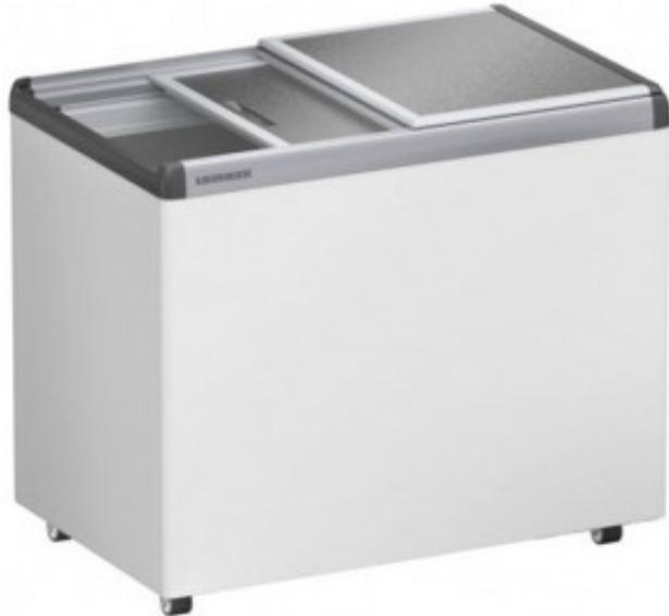
Flaschenkühltruhe mit stiller Kühlung, für den professionellen Dauereinsatz konzipiert, Temperaturbereich von +2°C bis +15°C, mit Aluminium-Schiebedeckel, äußerst robustes und stoßfestes Gehäuse, hochwirksame Isolation, geringer Energieverbrauch, perfekte Hygiene dank Aluminium-Innenbehälter (kratzfest und rostfrei), mechanische Steuerung, analoge Temperaturanzeige im Innenraum, abschließbar, mit Schloss, stabile Lenkrollen erleichtern den Transport
